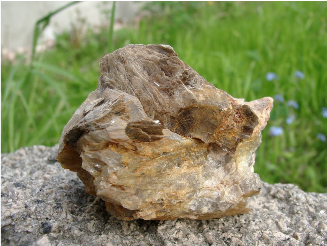
Abb. 3: Lepidolith mit ca. 4 % \text{Li}_2\text{O} aus einem Pegmatit bei Penig/Sachsen; Stufenbreite 6 cm (Sammlung Lehmann)
